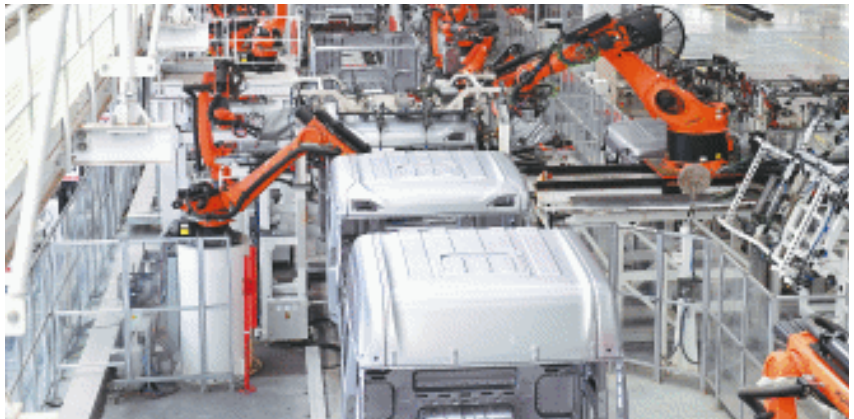
三一智联重卡产业园里，焊接机器人正在对重卡驾驶室进行焊接。长沙晚报全媒体记者 王志伟 摄
