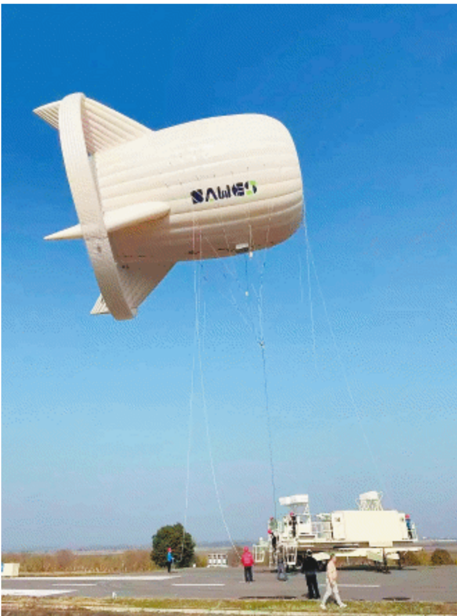
空天能源新技术不断出现,由北京临一云川能源技术有限公司联合多家科研机构共同研制的涵道式浮空风力发电系统可以利用充氦浮空器将轻量化的发电机组运升至500米高度,发电后通过系统将电能传输至地面。长沙晚报通讯员 朱莉 供图
